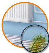
La temperatura del agua facilita la proliferación de microorganismos y algas que pueden causar obstrucciones y corrosión
