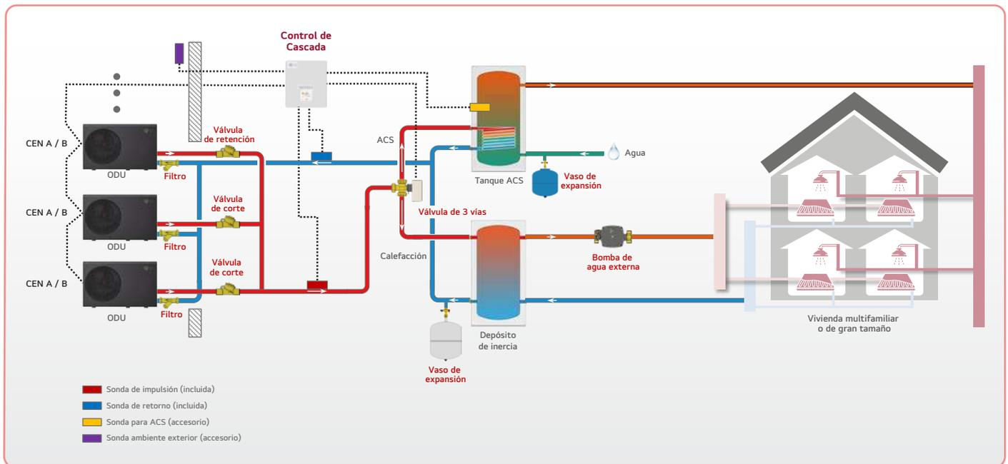
**Nota:** Es necesaria una disposición de tuberías de retorno inverso, ya que la bomba de agua de cada unidad solo se puede configurar con la misma capacidad.
