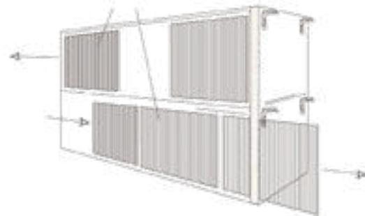
Filtro separado en 3 partes (acceso de mantenimiento por dos lados)
