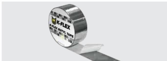
Cinta sellante auto-adhesiva, fabricada con goma de butilo y recubierta por una película de aluminio, disponible en varios tamaños. La cinta K-FLEX® BUTÍLICA, tiene un alto poder adhesivo, especialmente sobre plásticos, cristal, acero, policarbonatos y madera. Esta cinta, esta recubierta por una película de aluminio, haciéndola altamente resistente al envejecimiento y oxidación causada por agentes químicos y atmosféricos.
