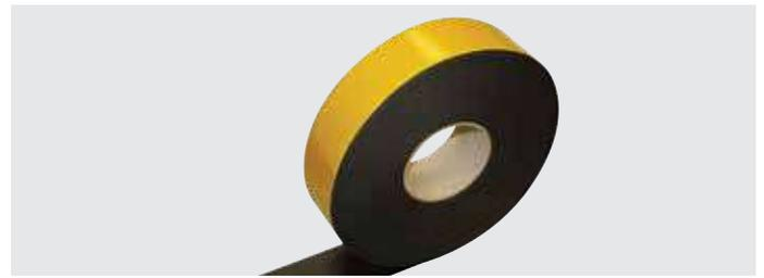
Cinta de espuma elastomérica flexible de célula cerrada (FEF), idónea para instalaciones de aislamiento térmico tanto para calor como para frío, ofrece una combinación de baja conductividad térmica, alta resistencia a la barrera de vapor y baja propagación de la llama.
