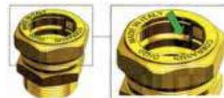
4) Manualmente libere la tuerca aproximadamente 1/2 vuelta, a no ser que ya lo esté. Introduzca la tubería en el racor hasta que sienta un "clack".
