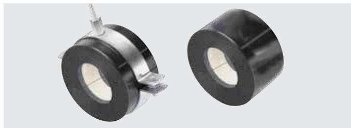
Diseñados específicamente para asegurar un espesor correcto y constante del aislamiento, donde se prevén las fijaciones de la tubería. La sección central de PIR, cubre toda la circunferencia de la tubería y está unido a dos secciones de material aislante K-FLEX®, asegurando una perfecta continuidad del aislamiento y su barrera de vapor.
