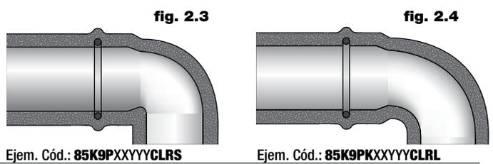
**3) CURVAS EN HIERRO FUNDIDO CON "ROSCA" NORMA 1/A SIN PERDIDA DE ESPESOR (figura 3)**
